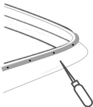
С помощью шила или отвертки, в местах установки элементов крепления рамки, делаем отверстия в уплотнителе, чтобы предотвратить налипание клеевой основы на саморезы.
